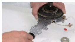
混合管のガス通路部の清掃
