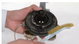
混合管周囲の清掃
